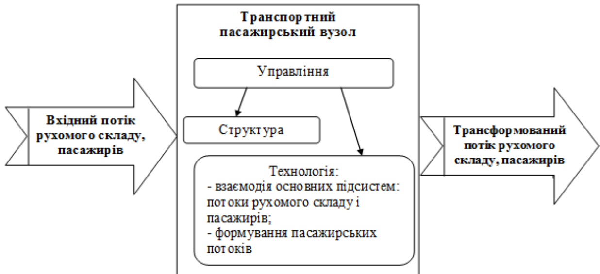
Рисунок 3.1 – Структурна схема транспортного пасажирського вузла великого міста
