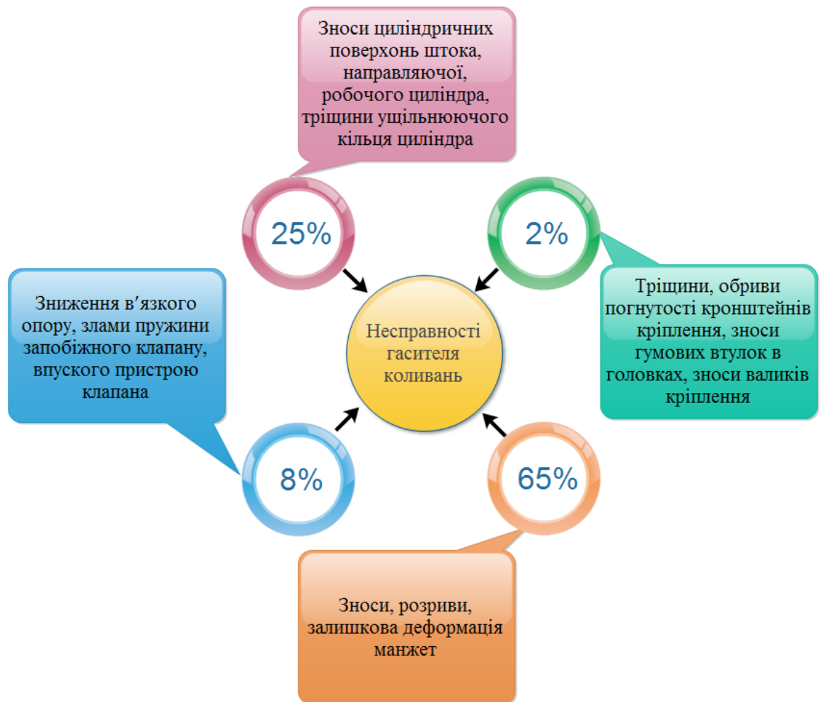
Рисунок 4.1 – Аналіз несправностей складових частин гідравлічного гасителя коливань типу НЦ-1100
