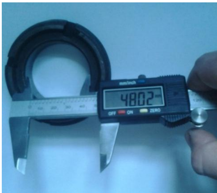
Рисунок 3.2 – Вимір внутрішнього діаметру направляючої цифровим штангенциркулем
