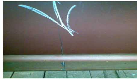
Рисунок 4 – Довгобазний вагон-платформа для перевезення контейнерів та довгомірних вантажів. Руйнування хребтової балки у місці «технологічного вікна» гальмівної системи та бокової балки перехідному перерізі
