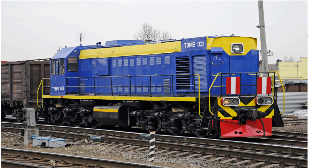
Рисунок 1.4 – Маневровий тепловоз ТЕМ18
