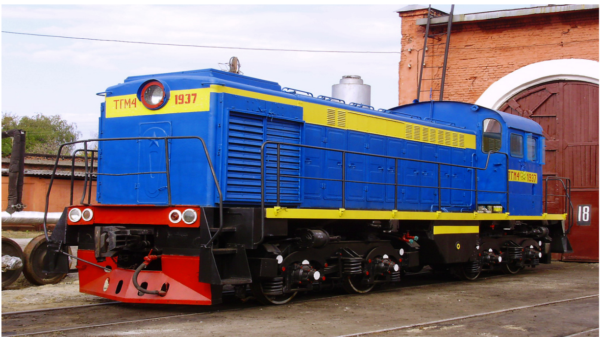
Рисунок 1.7 – Маневровий тепловоз з гідравлічною передачею ТГМ4
