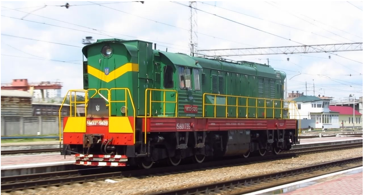
Рисунок 1.6 – Маневровий тепловоз ЧМЕЗ
