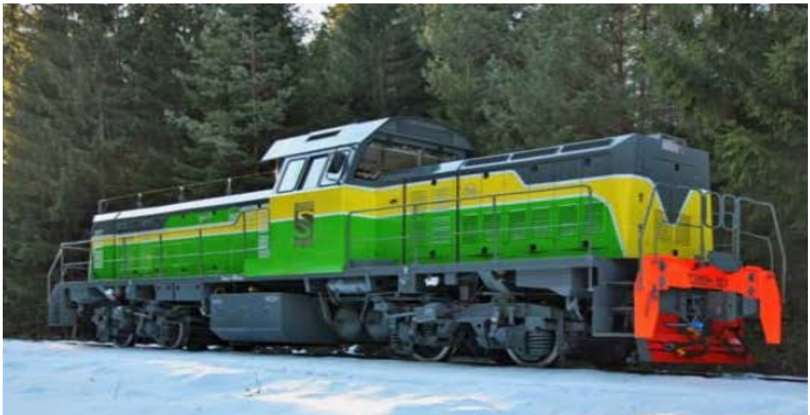
Рисунок 1.14 – Гібридний тепловоз ТЕМ9Н
