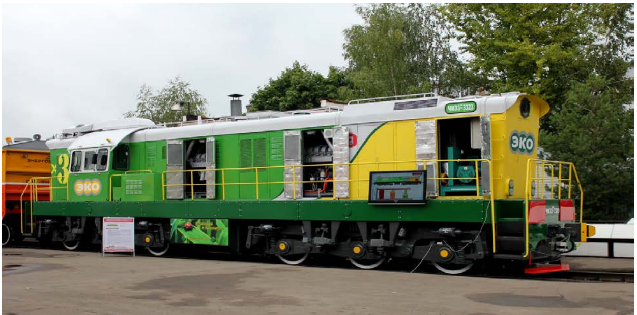
Рисунок 1.10 – Маневровий двоох дизельний тепловоз ЧМЕЗ ЕКО
