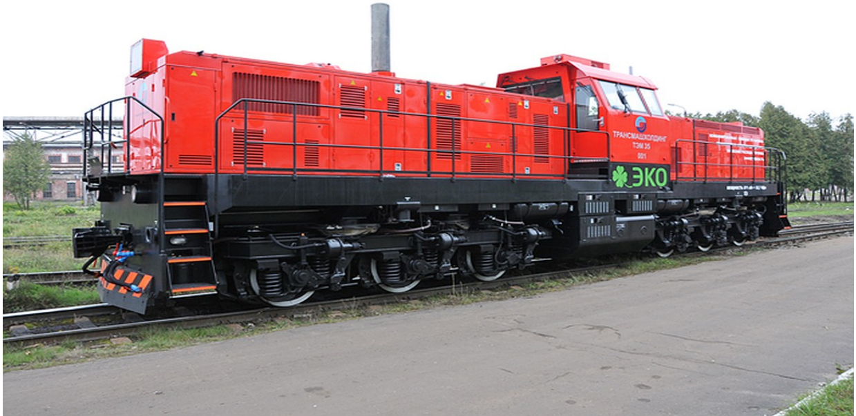
Рисунок 1.13 – Гібридний маневровий тепловоз ТЕМ35
