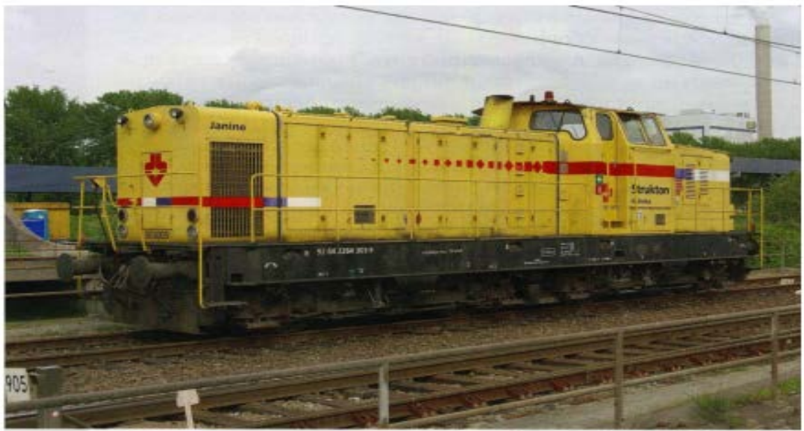
Рисунок 1.17 – Маневровий тепловоз із сонячною батареєю
