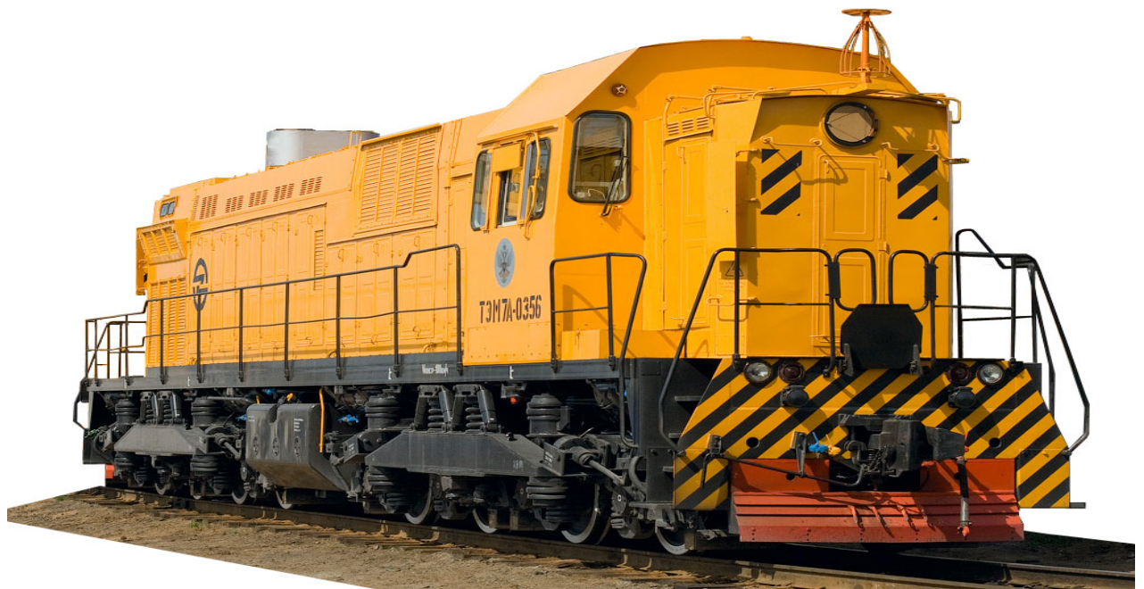
Рисунок 1.2 – Маневровий тепловоз ТЕМ7А
