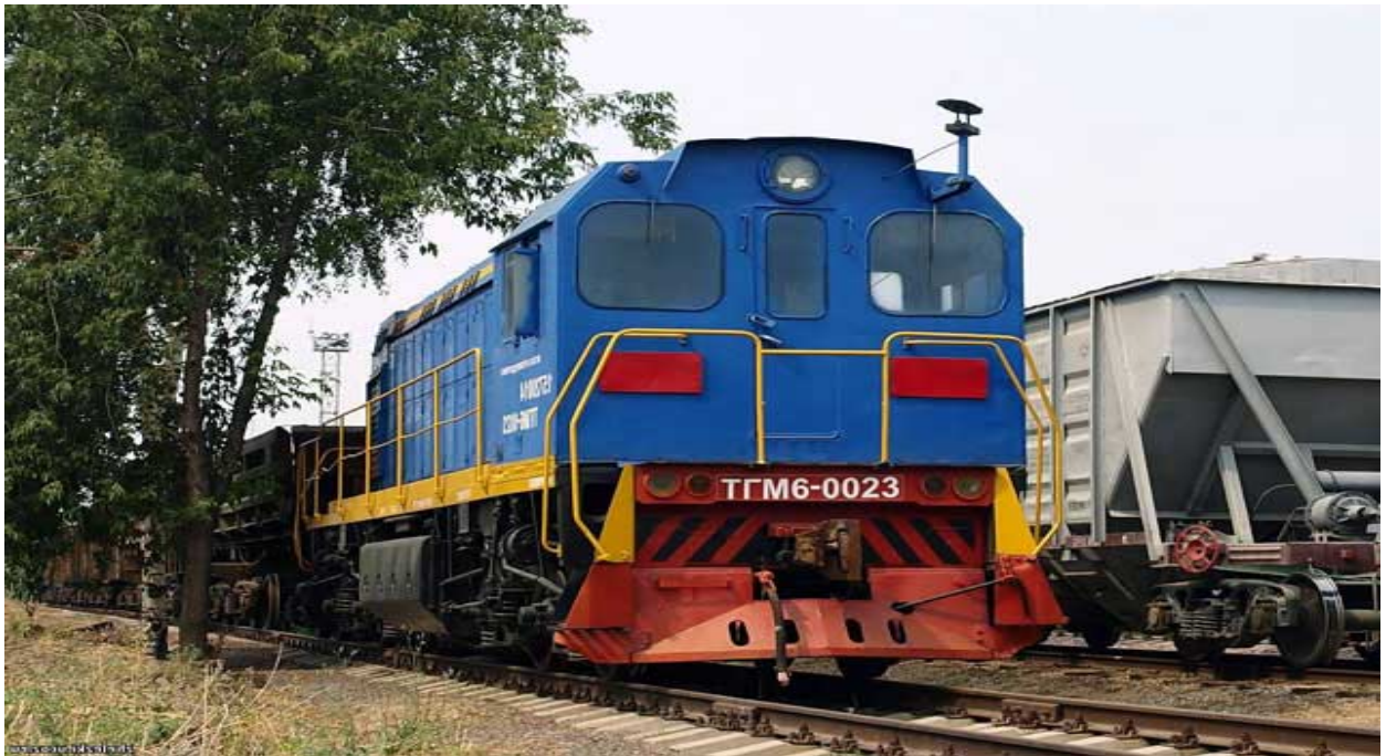
Рисунок 1.8 – Маневровий тепловоз з гідравлічною передачею ТГМ6
