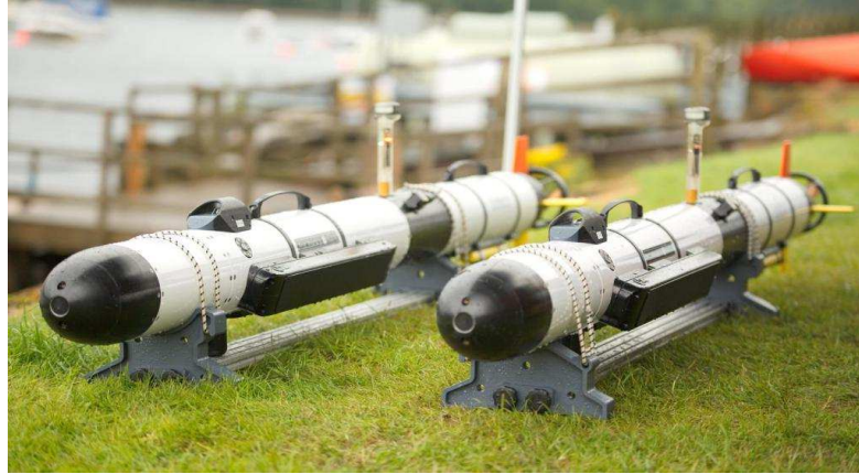
Рисунок 1.9 – Безпілотний автоматичний морський робот «Iver-3»
