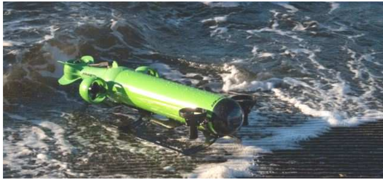
Рисунок 1.6 – Апарат « Aquabotix Hybrid » типу AUV/ROV
