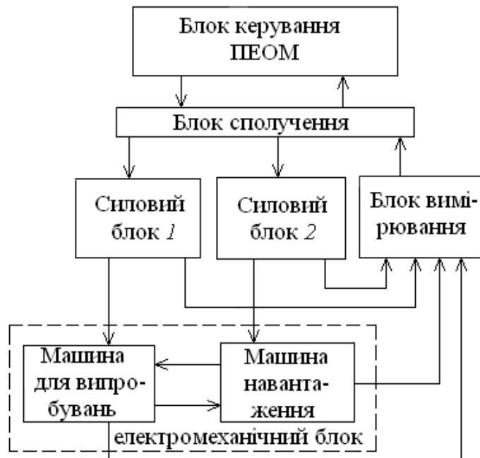
Рисунок 7.1 – Функціональна схема «Стенда випробувального СВ-1»
