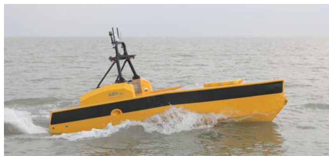
Рисунок 1.7 – Надводне багатоцільове безпілотне судно « C-Worker 5 »
