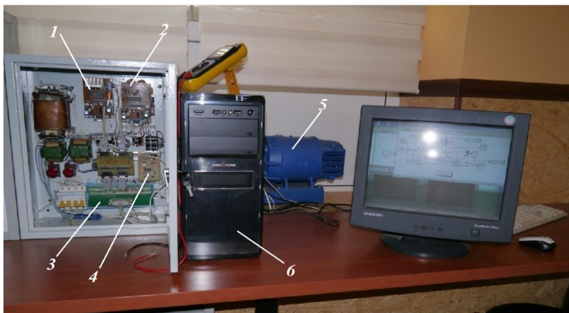
Рисунок 10 – Фото спеціалізованого моделюючого комплексу: 1 – силовий блок-1; 2 – силовий блок-2; 3 – блок інтерфейсу; 4 – блок вимірювання; 5 – електромеханічний блок; 6 – блок керування (ПЕОМ)
