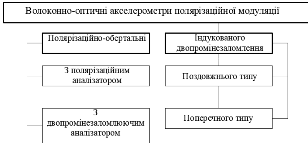
Рисунок 2.8 – Види та типи поляризаційних ВОА
