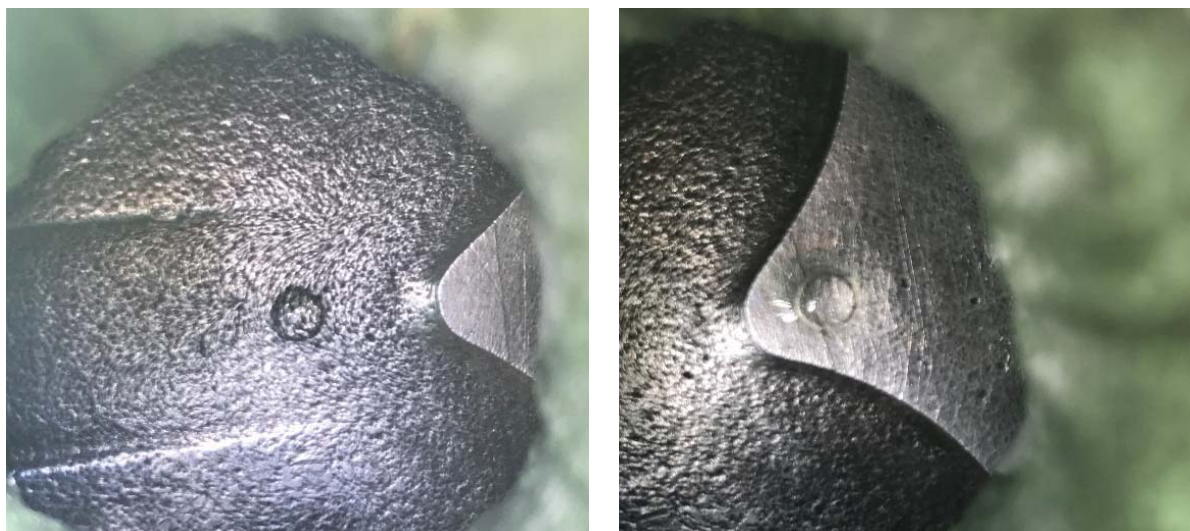
Рисунок 3.5 – Відеореєстрації процесу випаровування краплі емульсії дизельного палива з водою. а) на початку процесу випаровування, б) процес випаровування
