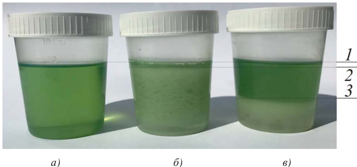
Рисунок 3.9 – Фотографії дизельного палива (а) звичайної (б) і мікрогетерогенної (в) емульсії
