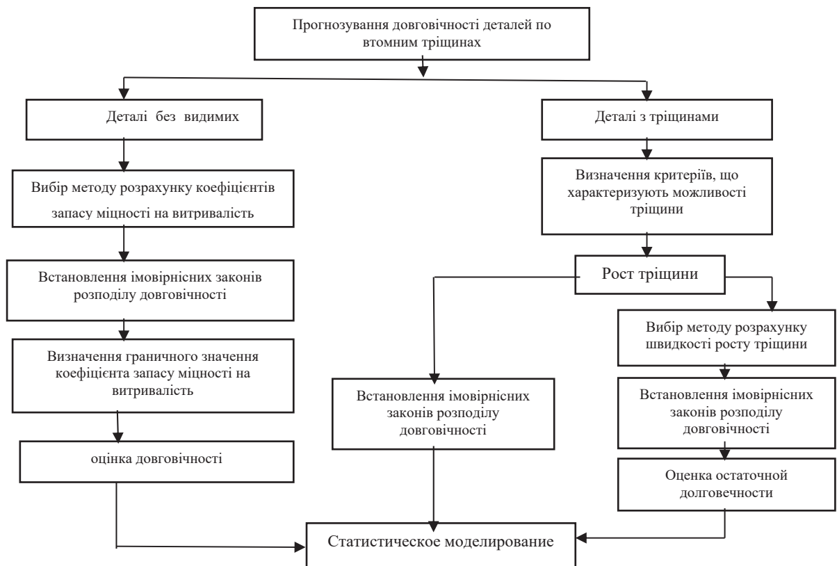
Рисунок 4.13 – Блок-схема алгоритму процедури оцінювання довговічності деталей судових ДВС по втомній міцності
